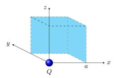
Berechnen Sie den elektrischen Fluss durch die Würfelflächen, die die Punktladung nicht berühren (in der Skizze blau gekennzeichnet).
