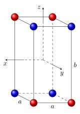
Die roten Kugeln stehen für Punktladungen q > 0 und die blauen Kugeln für Punktladungen -q. Der Ursprung des Koordinatensystems befinde sich genau in der Mitte.
