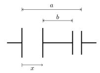
(a) Berechnen Sie die gesamte Kapazität beider Kondensatoren als Funktion von x.
