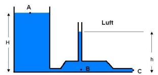
Ein mit Wasser gefüllter Behälter sei mit einem Rohr (Querschnitt  $A_C$ ) verbunden, über das das Wasser abfließen kann (siehe Abbildung). Am Ende des Rohres tritt das Wasser an die Luft aus. An einer Verdickung des Rohres (Querschnitt  $A_B$ ) befindet sich ein Steigrohr.
